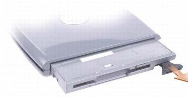
5. Insérez le nouveau périphérique dans la baie, poussez-le jusqu'à ce qu'il s'enclenche, puis poussez le dispositif de verrouillage du périphérique de façon à ce qu'il ne dépasse pas de l'ordinateur.
