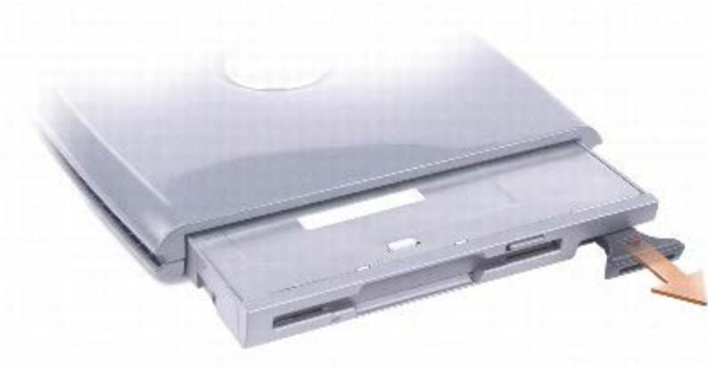
3. Insérez le nouveau périphérique dans la baie, poussez-le jusqu'à ce qu'il s'enclenche, puis poussez le dispositif de verrouillage du périphérique de façon à ce qu'il ne dépasse pas de l'ordinateur.
